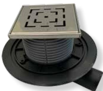
Pozzetto scarico orizzontale DN50 senza telo, senza flangia, con cornice acciaio.
